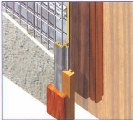
Montantes verticales reforzados
